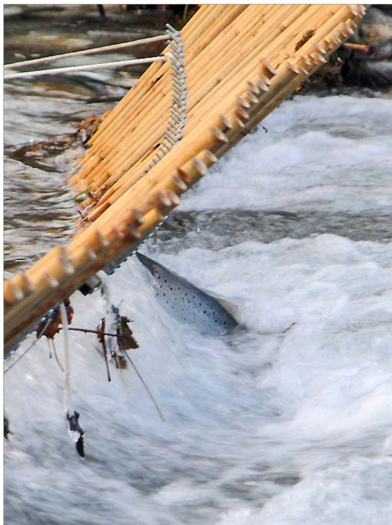
Abb.4: Feldversuch 2012: Eine Seeforelle versucht vergeblich die Seeforellenweiche zu passieren (Foto M. Meyer, KWO)
